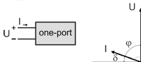
شکل ۱- دیگرام برداری ولتاژ و جریان به همراه زاویه تلفات
